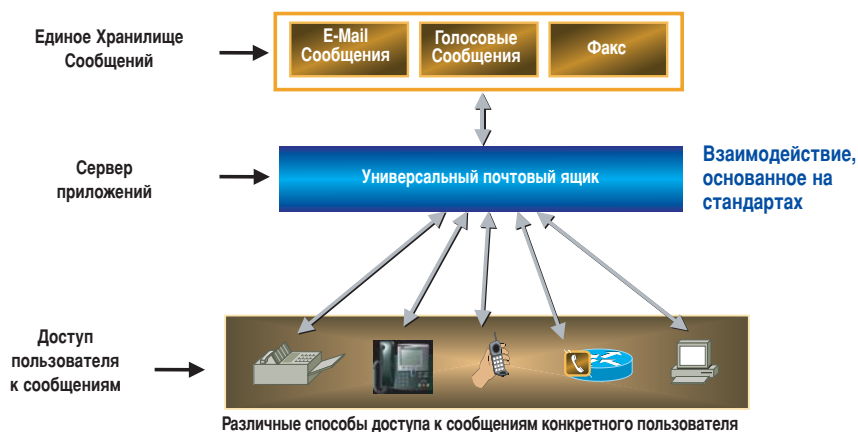
Рисунок 20. Принципы функционирования системы универсальной обработки сообщений
